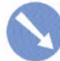
(P - 52b) Υποχρεωτική δέλευση μόνο από τη δεξιά πλευρά της νησίδας ή του εμπόδου.
