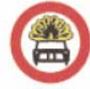
(P - 45) Απαγορεύεται η είσοδος σε οχήματα που μεταφέρουν πάνω από ορισμένη ποσότητα εκρηκτικών ή εύφλεκτων υλικών.
