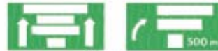
(Π - 84) Γέφυρα σήμανσης με αναγραφή καταβύθιστων προ αναστέδου κόμβου με αναγραφή λωρίδας του αυτοκινητοδρόμου.
