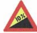
(Κ - 4) Απότομη ανωφάρα, (με κλίση όπως η ανα- γραφόμενη στην Πινα- κίδα).
