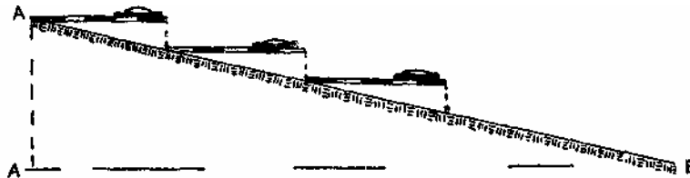
Σχήμα 36. Τοποθέτηση των μετροταινιών για τη μέτρηση κλιμακιδών.
